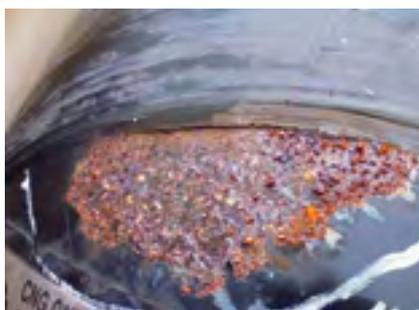
Korrosion an den Gastanks führte beim VW Touran erneut zu Problemen.
